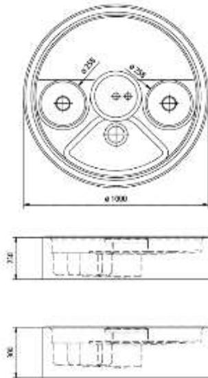
Rundspüle aus Edelstahl mit Rahmen zum Einbau in/auf einen bauseitigen Korpus. Einbau in Brücken-, Zeile- oder Ecklage möglich. Rahmen mit werkseitig vormontierter Rundspüle.
