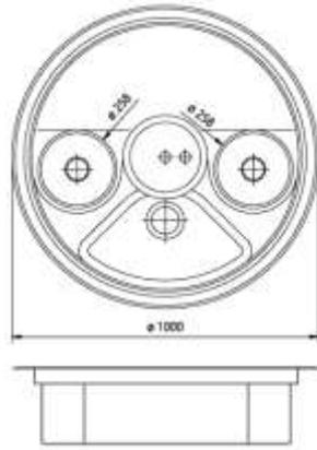
Rundspüle aus Edelstahl, ohne Rahmen und ohne Unterbau, zum Einbau in Arbeitsplatte aus Holz, Granit oder Edelstahl.
