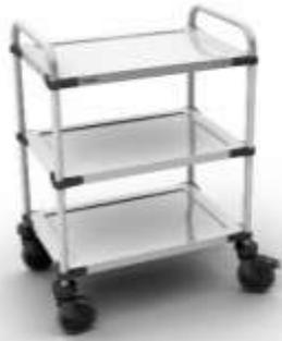
Servierwagen aus Edelstahl, Rundrohr-Schiebebügel, tiefgezogene Borde mit Stopprand, schallgedämmt, Schraubkonstruktion, max. Flächenbelastung pro Bord 80 kg. Rostfreie Rollenausstattung gemäß DIN 18867. Raddurchmesser 125 mm mit Stossecken an jedem Bord, 4 Abweiserrollen, 2 Lenkrollen, 2 Lenkstoprollen.
