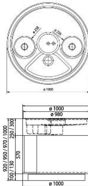
System aus Edelstahl in Inselzeile oder Ecklage möglich. Komplett mit Rundspüle, Rahmen, Korpus, Schiebetüre und Sockel. Fünf höhenverstellbare Füße.
